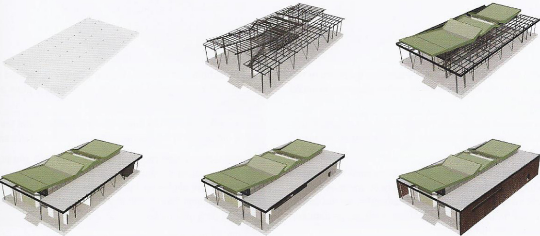
Φάσεις Κατασκευής | Construction Phases
